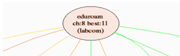
Figura 2.7: Eleição do melhor canal de um ponto de acesso.
